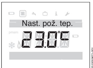
Obr. 11 Požadovaná hodnota teploty prostoru
