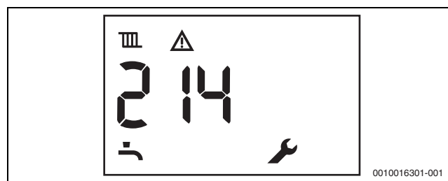
Obr. 130 Příklad: Porucha nezpůsobující zablokování
