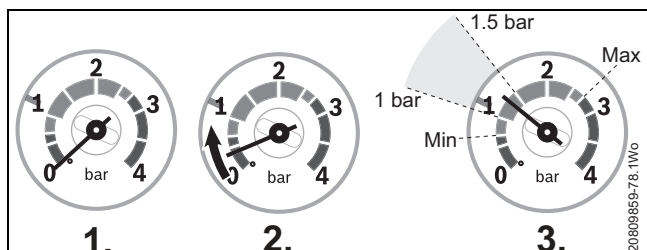
Obr. 26 Nastavení tlaku v systému
